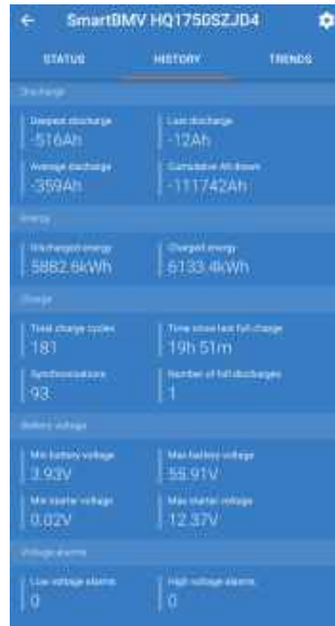
Application VictronConnect affichant l'historique du contrôleur de batterie BMV
