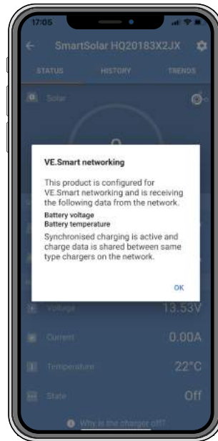
Fenêtre contextuelle du réseau VE.Smart
