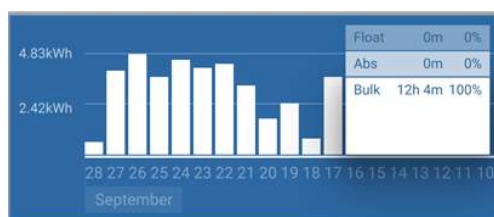
Système passant tout son temps en mode Bulk avec détails des étapes de charge — Système à l'étape Bulk et Absorption
