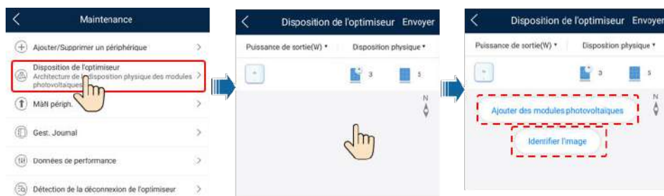
Figure 7-7 Disposition physique des modules PV
