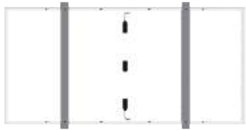
Installation avec des boulons à 4 trous intérieurs Support transversal perpendiculaire aux côtés longs
