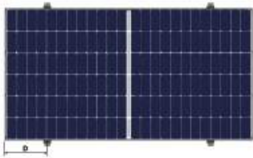
Installation avec des outillages de fixation au côté long du module encadré (Support transversal perpendiculaire aux côtés longs) (longueur de pièce \geq 50\text{mm} )
