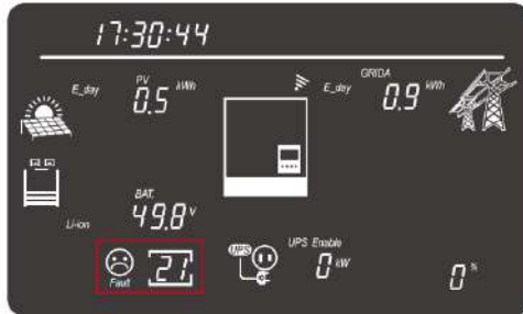
État de défaut, défaut 21
