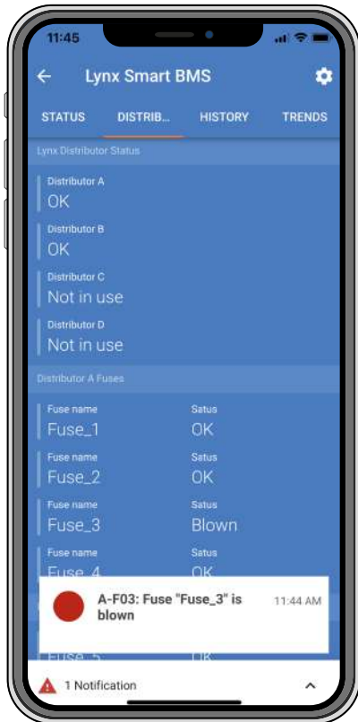
Exemples d'alarme relative aux fusibles dans l'application VictronConnect et sur un dispositif GX
