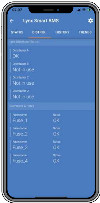
Application VictronConnect dans le Lynx Smart BMS affichant l'état du distributeur Lynx
