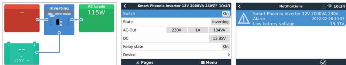
Exemples d'écrans du dispositif GX de gauche à droite : écran du système, écran du convertisseur et message d'alarme.
