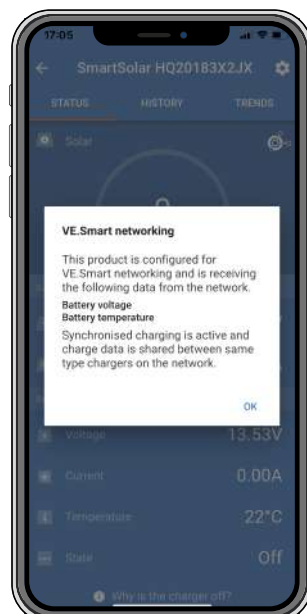
Fenêtre contextuelle du réseau VE.Smart Networking
