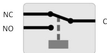
Fonctionnement interne du relais programmable
