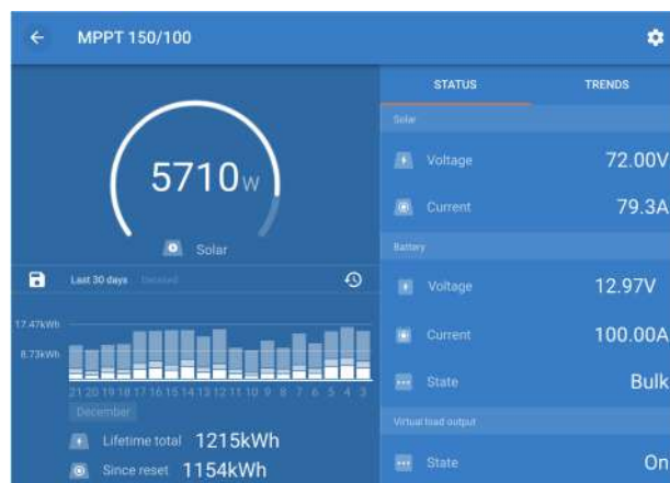
Capture d'écran de l'application VictronConnect affichant les données en temps réel et les données historiques.
