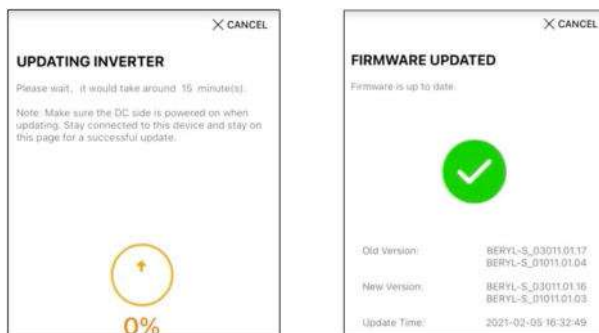
figure 6-9 Mise à niveau de l'onduleur
