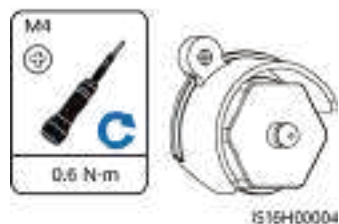
Figure 5-37 Installation des composants antivol du Smart Dongle
