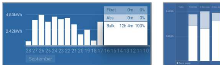
Système passant tout son temps en mode Bulk avec détail des phases de charge — Système à la phase Bulk et Absorption
