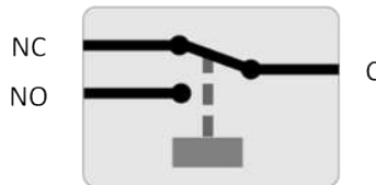
Fonctionnement interne du relais programmable
